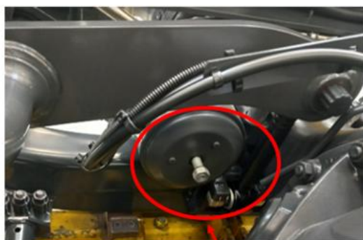
Prawidłowo wykręcona śruba zacisku
